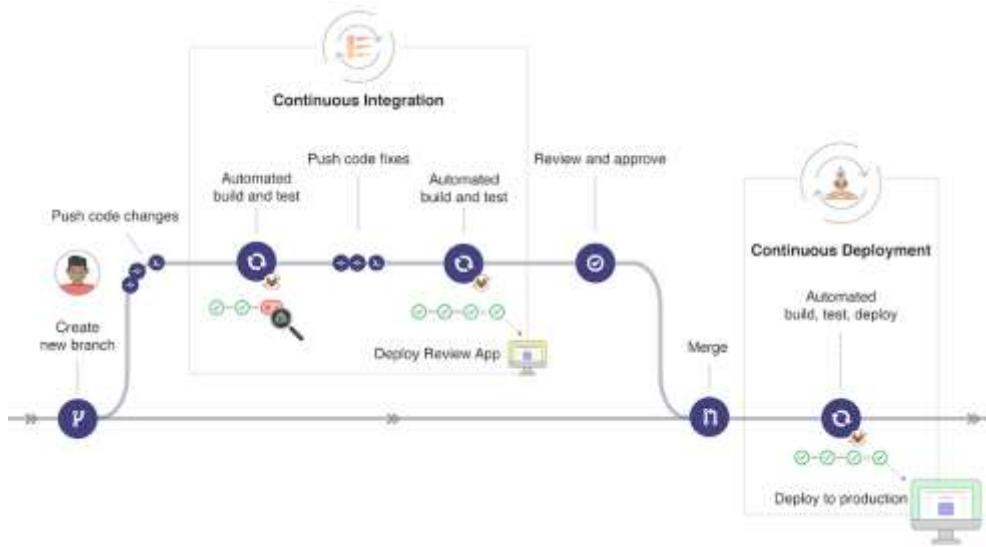
Figure 3.5 – Visualisation of the CI/CD pipeline.<sup>248</sup>
