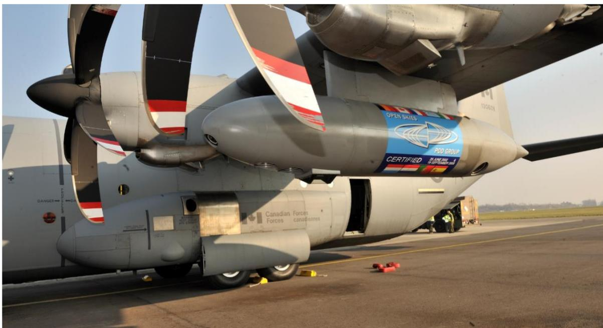
Figure 5 : La nacelle SAMSON, système d'imagerie à film argentique
